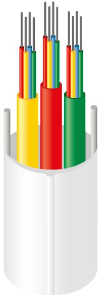
**Description Produit :** Ce câble micromodule riser colonne montante à une capacité de 12 à 144 FO monomode G657A2 et chaque modulo peut accueillir 4, 6 ou 12 FO. Il est utilisé en intérieur pour le réseau FTTH (Fiber To The Home) pour permettre le déploiement de la fibre optique dans l'intégralité de l'immeuble.
